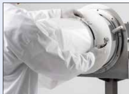
Endlosfolie auf Trägerrohr abdichten
