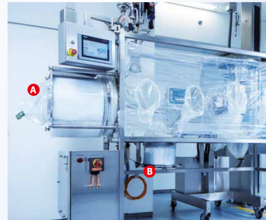
A CLS horizontal: Schleuse
