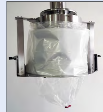
Schieben Sie die Teleskopstangen gleichmässig nach oben. Verschliessen Sie mit dem SafeSeal Verschluss System.
