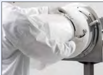
Endlosfolie auf Trägerrohr abdichten
