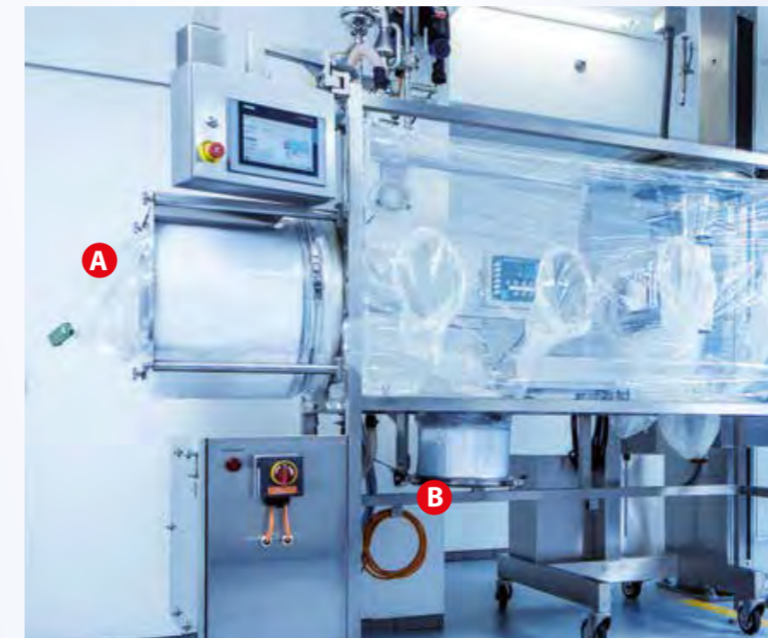
A CLS horizontal: Schleuse
