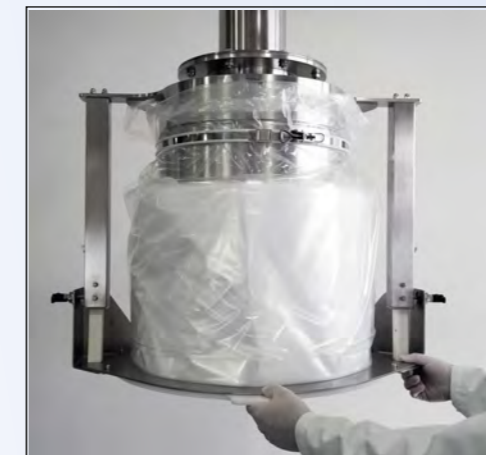
Ziehen Sie die äußerste Falte über den Linerträger. Verschliessen Sie mit dem Klemmring.
