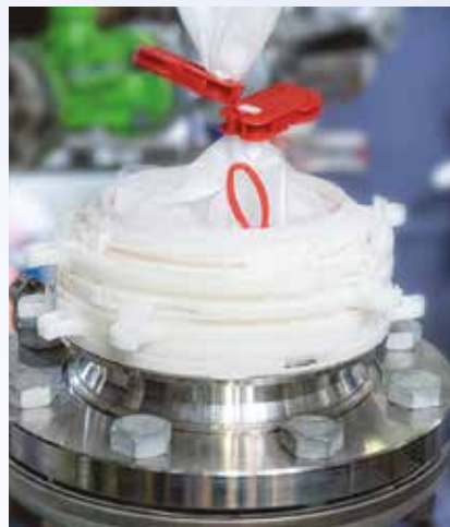
Abtrennen des SafePortBags mittels SafeSeal System
