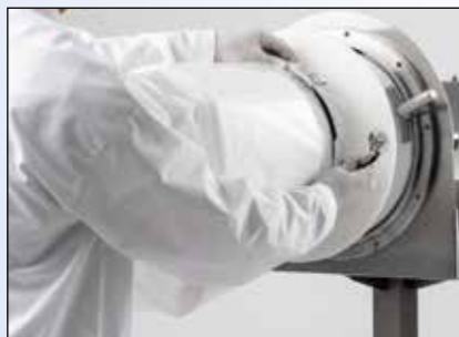
Endlosfolie auf Trägerrohr abdichten
