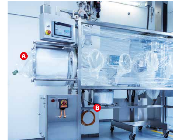
A CLS horizontal: Schleuse
