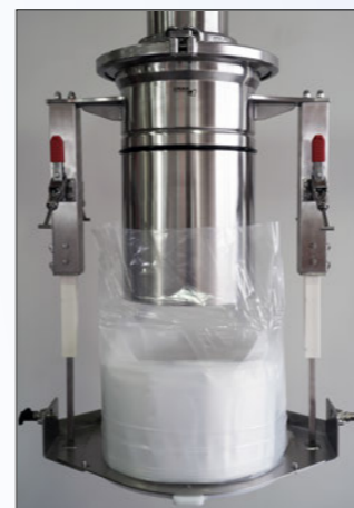
Linerträger mit Bestückungshilfe wird für die Bestückung vorbereitet
