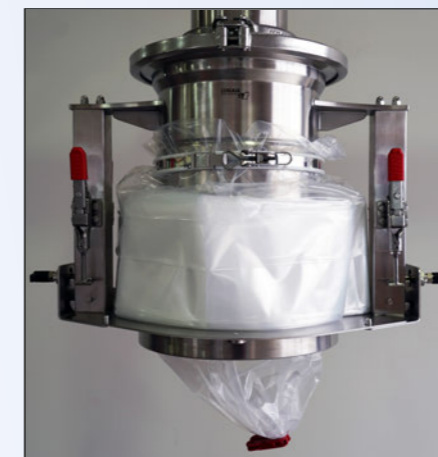
Endlosliner fertig bestückt und bereit zur Abfüllung
