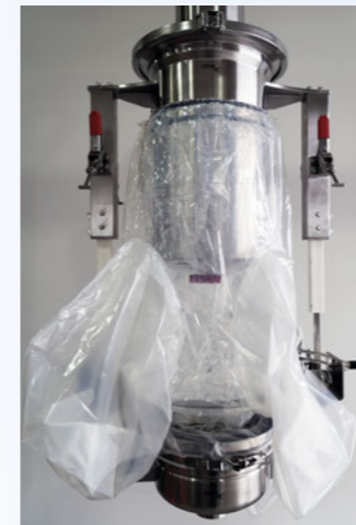
Linerträger mit Waschglocke und Reinigungssleeve
