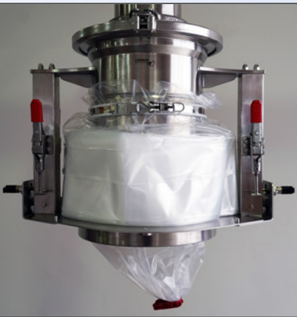
Endlosliner fertig bestückt und bereit zur Abfüllung
