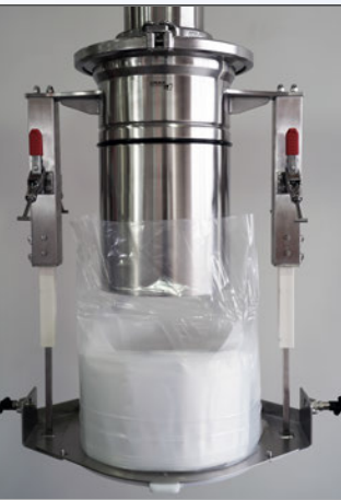
Linerträger mit Bestückungshilfe wird für die Bestückung vorbereitet
