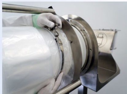
Endlosfolie auf Trägerrohr abdichten
