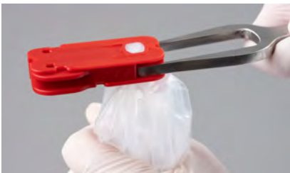
Öffner einstecken, der äußere Crimp öffnet sich
