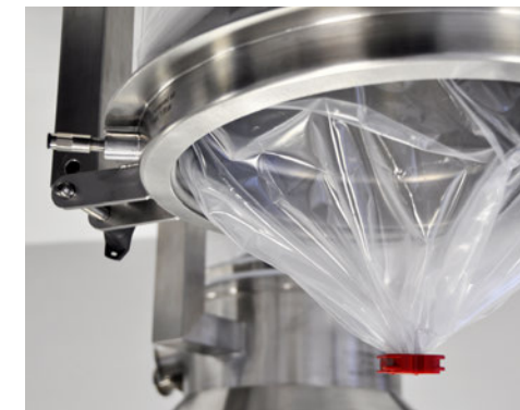
Linerträger mit Blähschlauch zur Abdichtung
