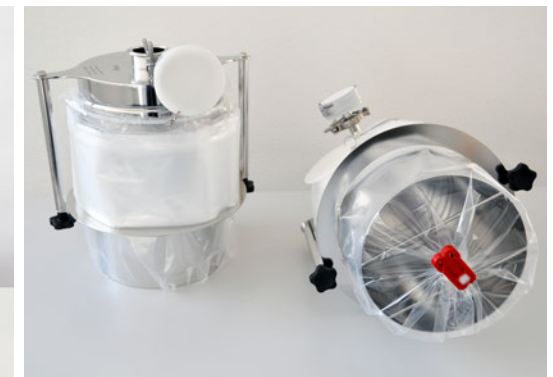
Linerträger für kontaminationsfreien Austrag aus der Tablettenpresse
