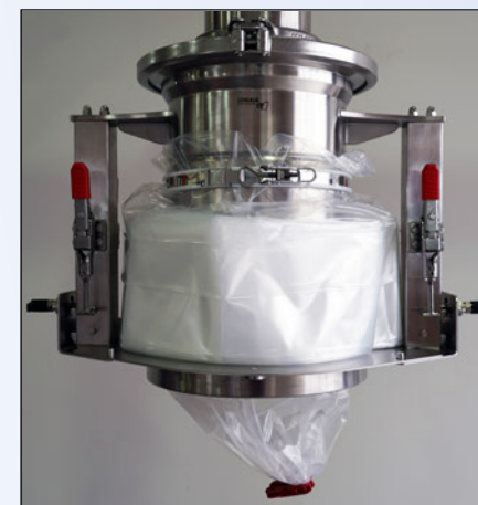
Endlosliner fertig bestückt und bereit zur Abfüllung
