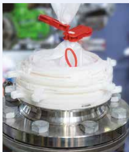
Abtrennen des SafePortBags mittels SafeSeal System
