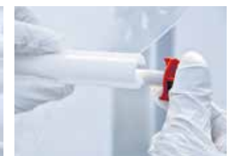
Den runden Stab aus dem Omega-Profil drücken
