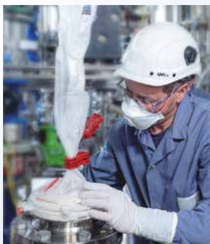
Verschließen des SafePortBags mittels SafeSeal System
