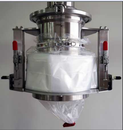
Endlosliner fertig bestückt und bereit zur Abfüllung
