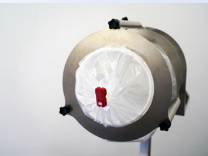
Endlosfolie mit SafeSeal verschließen
