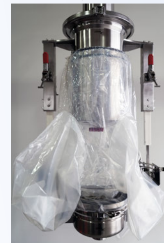
Linerträger mit Waschglocke und Reinigungssleeve
