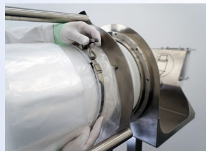
Endlosfolie auf Trägerrohr abdichten
