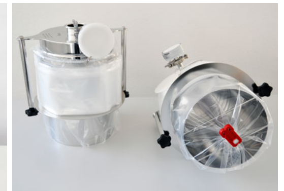
Linerträger für kontaminationsfreien Austrag aus der Tablettenpresse
