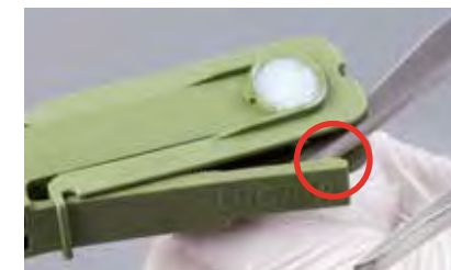
Aufbrechen des Sicherungsbügels auf beiden Seiten
