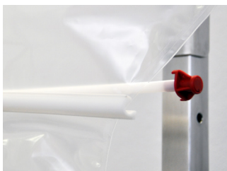
Den SafeStick am Transfer-Bag anbringen.
