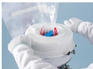
1. Anschliessen des Transfer-Bags mit einer Drehung bis PositionsIndikator grün.
