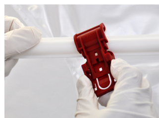
Die Sicherungsklemme durch leichtes Drehen öffnen.
