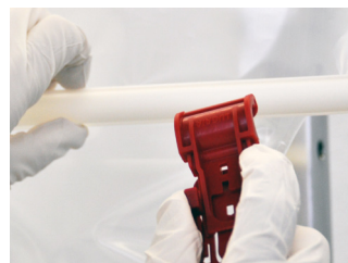
Die Sicherungsklemme am SafeStick anbringen.
