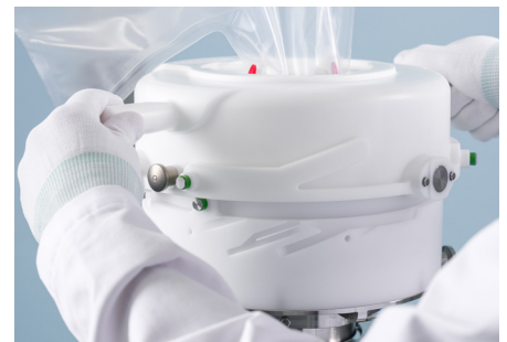
Bestückungshilfe mit Positionsindikator andocken.
