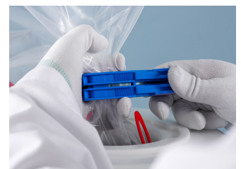
4. Crimpen und Schneiden mit dem Lugaia SafeSeal System.
