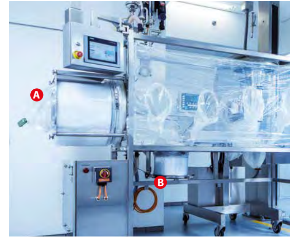
A CLS horizontal: Schleuse
