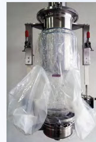
Linerträger mit Waschglocke und Reinigungssleeve
