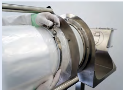
Endlosfolie auf Trägerrohr abdichten
