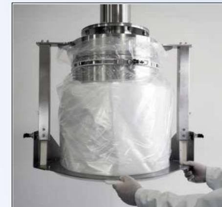
Ziehen Sie die äusserste Falte über den Linerträger. Verschliessen Sie mit dem Klemmring.
