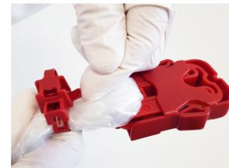
Öffnen des Schutzdeckels mittels Lasche
