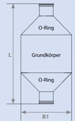
Einlass/Auslass mit eingearbeitetem O-Ring
