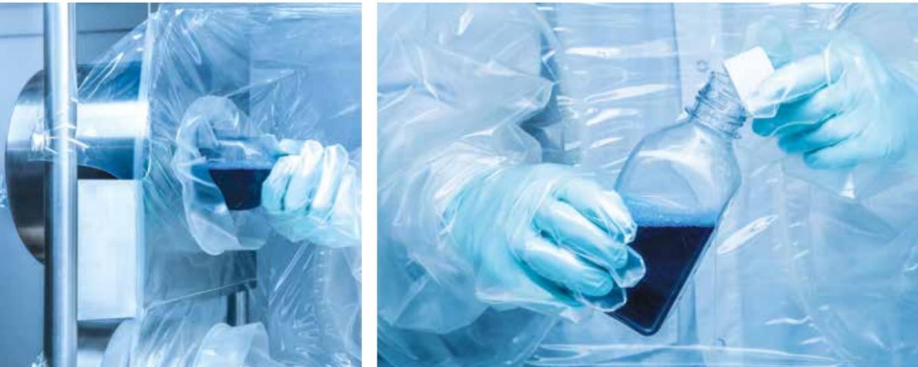
Isolatoren werden dazu eingesetzt, die Umgebung bzw. den zu verarbeitenden Stoff zu schützen. Ein sehr gut geplanter flexibler Containment-Isolator kommt einem Edelstahl-Isolator in Bezug auf die Absicherung sehr nahe und kann, je nach Anwendung, diverse Vorteile bieten.
